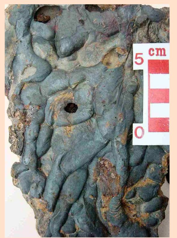
Ce type de laitier de fonte, commun dans la région de La Ferrière, est typique de la technique sidérurgique des bas-fourneaux en usage au Moyen-Âge.
