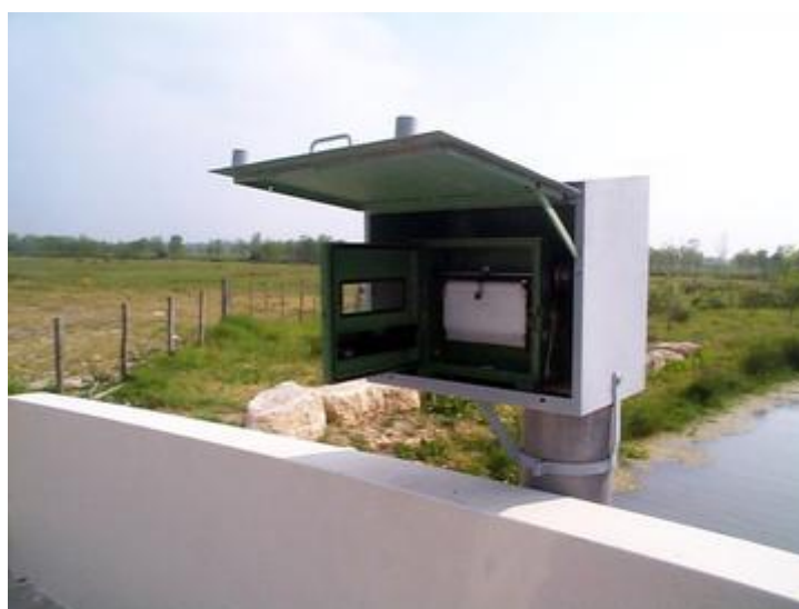
Limnigraph pour le suivi des niveaux d'eau dans le bassin du Lay - Bot Bourdin
