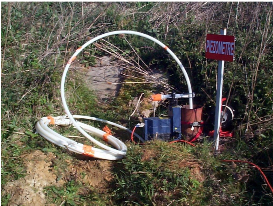
Prélèvement d'eau souterraine pour analyse à St Martin des Fontaines (forage équipé d'un piézomètre pour le suivi du niveau de la nappe).
